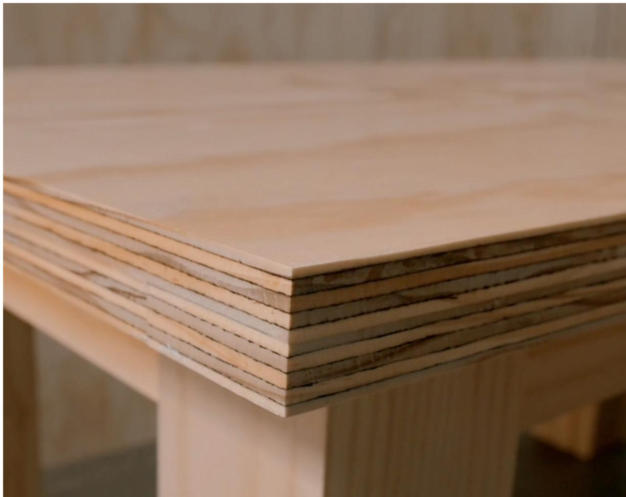
En este número les presentamos algunas técnicas para engrosar los cantos del triplay. El tablero Mueblería de ARAUCOPLY, está disponible en espesores de hasta 18 mm.
